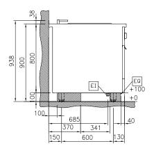
Drain Electrical inlet (power) Equipotential screw Water inlet
